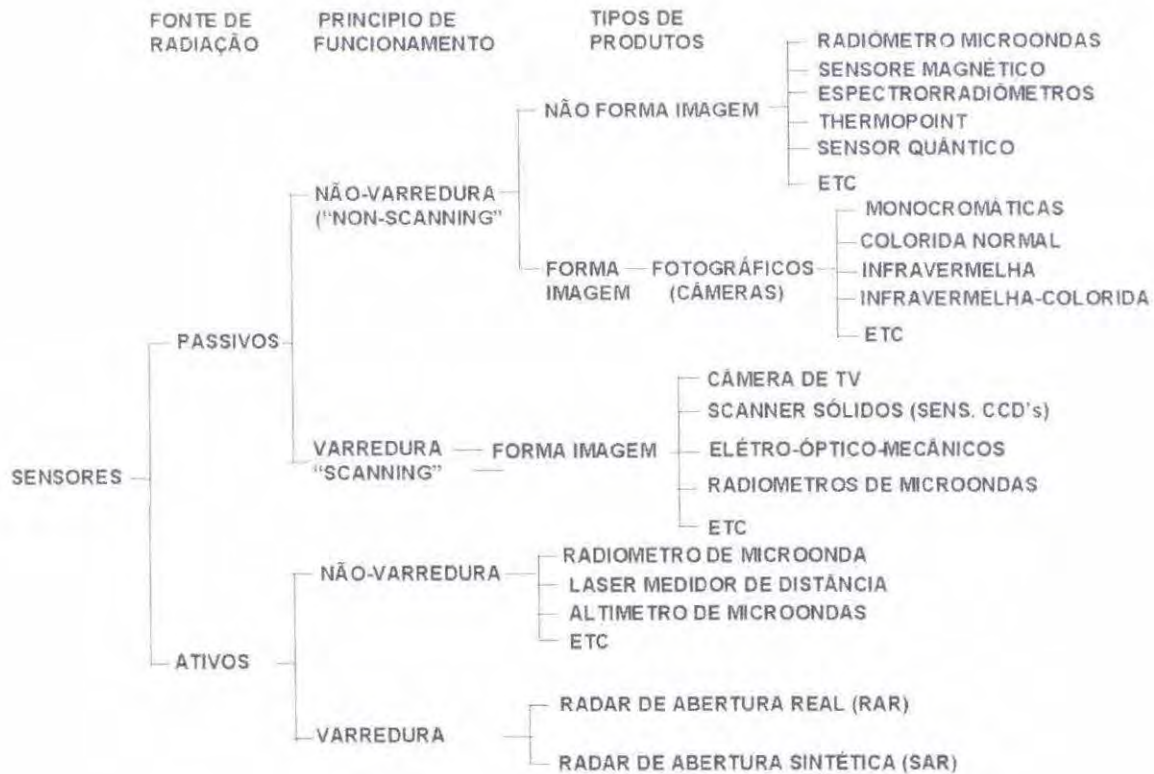
Fig.6.7 – Classificação dos sistemas sensores quanto à categoria, tipo de produto e fonte de radiação.
