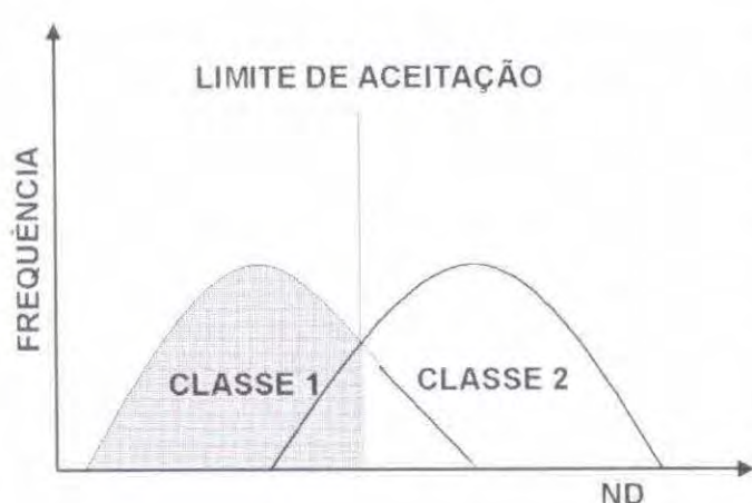
Fig.15.20 – Esquema da distribuição de frequência de “pixels” de duas classes imaginárias, para enfatizar o limite de aceitação.
