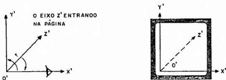
b- Sistema de coordenadas da mão esquerda (usado para as coordenadas de visualização).
