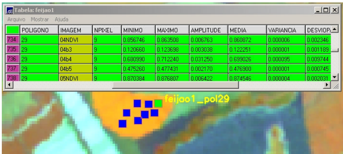
FIGURA 3.6 – Exemplo de um objeto espacial (polígono 29) da classe feijão 1 e alguns dos seus atributos: parâmetros estatísticos das bandas b3, b4 e b5 e do NDVI para a quarta data (29 de maio de 2002).
