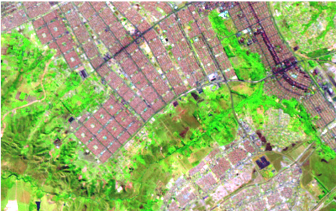
FIGURA 6.25 - Composição colorida com imagens interpoladas por convolução cúbica, (3B, 4G, 5R) com pixel = 15 m.
