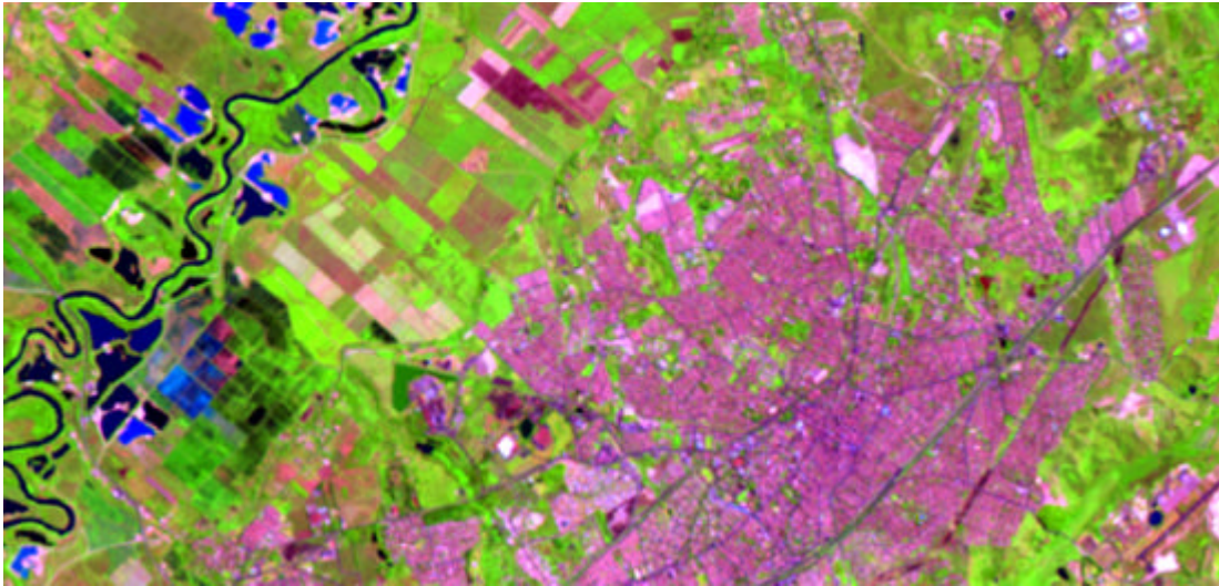
FIGURA 6.38 - Composição colorida com imagens interpoladas por convolução cúbica, (3B, 4G, 5R) com pixel = 10 m.
