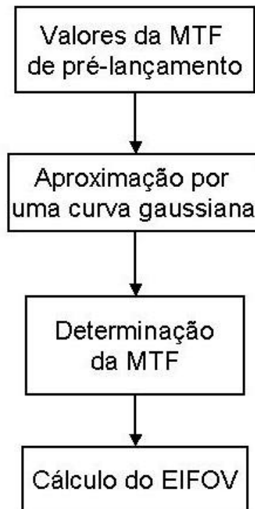
FIGURA 4.9 - Metodologia para a determinação da FTM por um modelo gaussiano.
