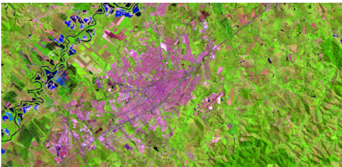
FIGURA 6.37 - Composição colorida com imagens originais, (3B, 4G, 5R) com pixel = 30 m.
