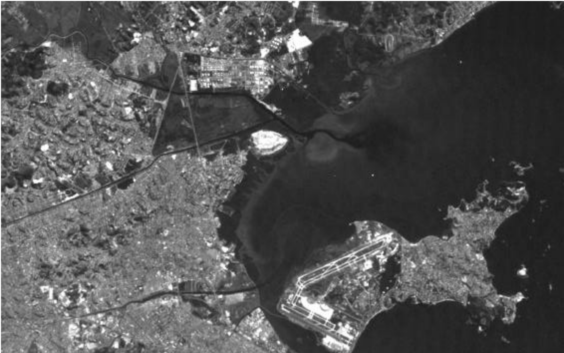
FIGURA 6.6 - Imagem interpolada por Convolução Cúbica, banda 3, pixel = 15 m.
