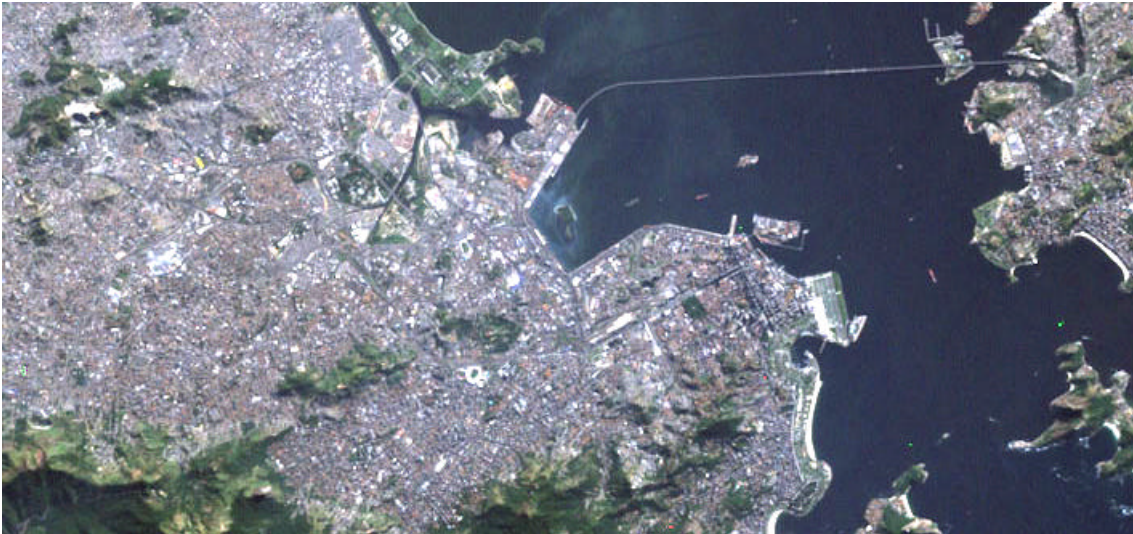
FIGURA 6.8 - Composição colorida com imagens originais, (1B, 2G, 3R) com pixel = 30 metros.
