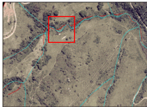
Figura 5.10 – En el drenaje se muestran muchas áreas con desplazamiento, esto se puede observar mas claramente en el área que se presenta con el rectángulo color rojo.
