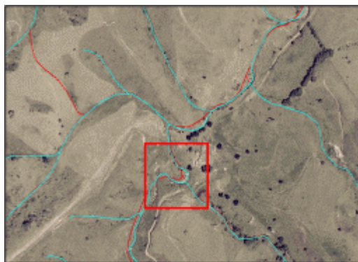
Figura 5.11 – Se observa desplazamiento en la red de drenaje, en comparación del drenaje ya existente.
