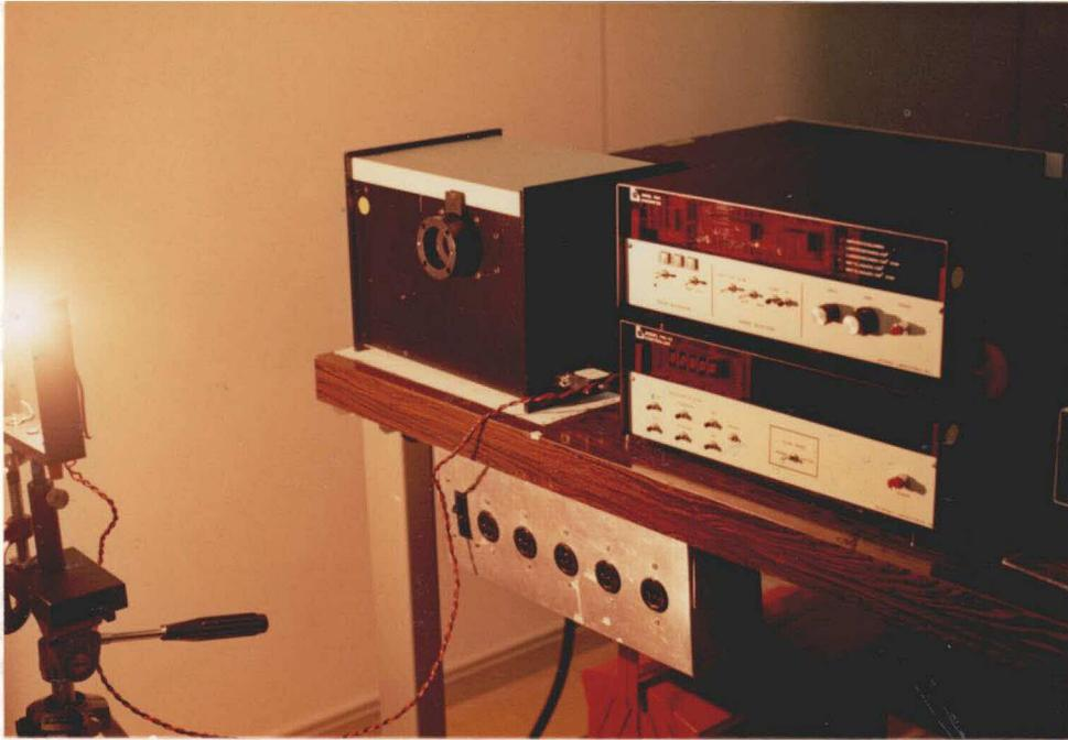
Fig. 4.20 - Experimento de calibração do OPTRONIC 740A.
