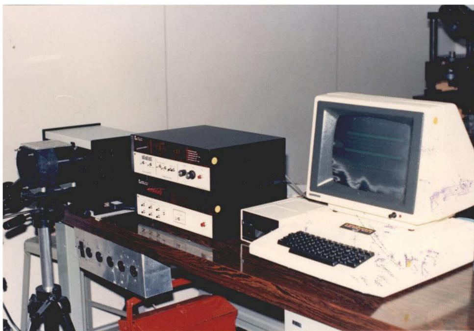
Fig. 4.11 - Sistema de medição de radiação óptica OPTRONIC 740A.
