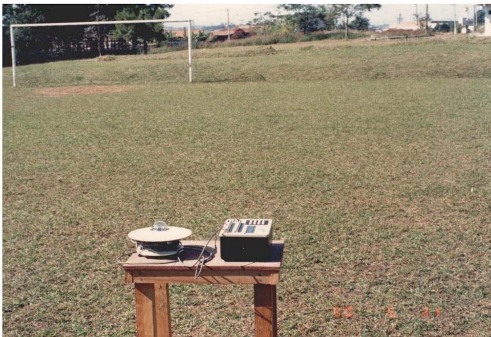
Fig. 4.9 - Sistema de medição de irradiância total.
