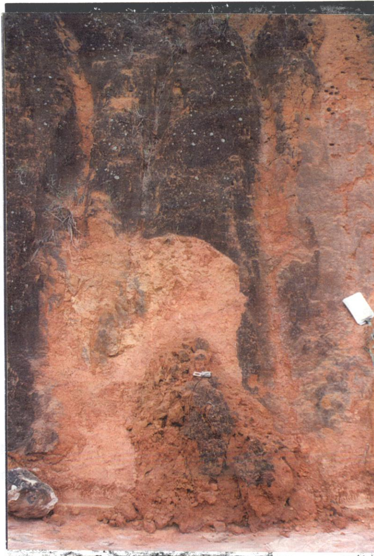
Fig. 4.21 - Escorregamentos de solo do tipo translacional. O escorregamento ocorreu segundo a direção da foliação (N50E/vertical) que é paralela ao corte de estrada (paralela à prancheta). BR-101, sentido Caraguatatuba-Ubatuba.
