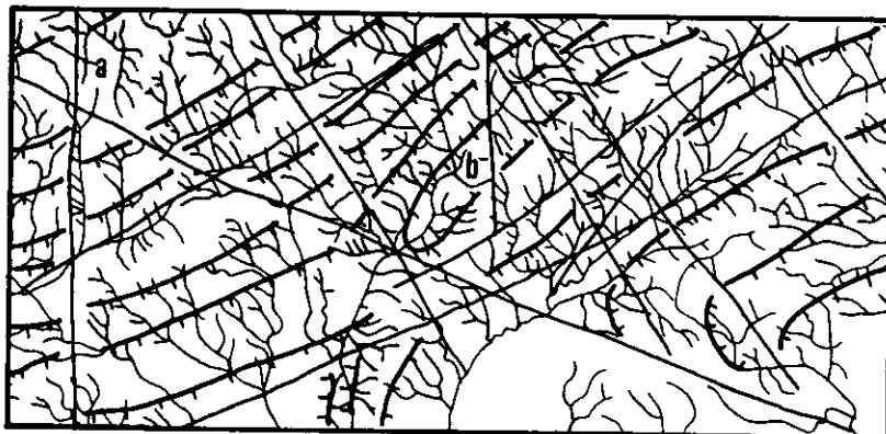
Fig. 3.5 - Exemplo de interpretação de altos (domos - a) e baixos (bacias - b) estruturais pela assimetria da rede de drenagem.
