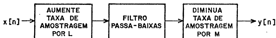
Fig. 2.3 - Representação em diagrama de blocos do aumento da taxa de amostragem por um fator de L/M .
