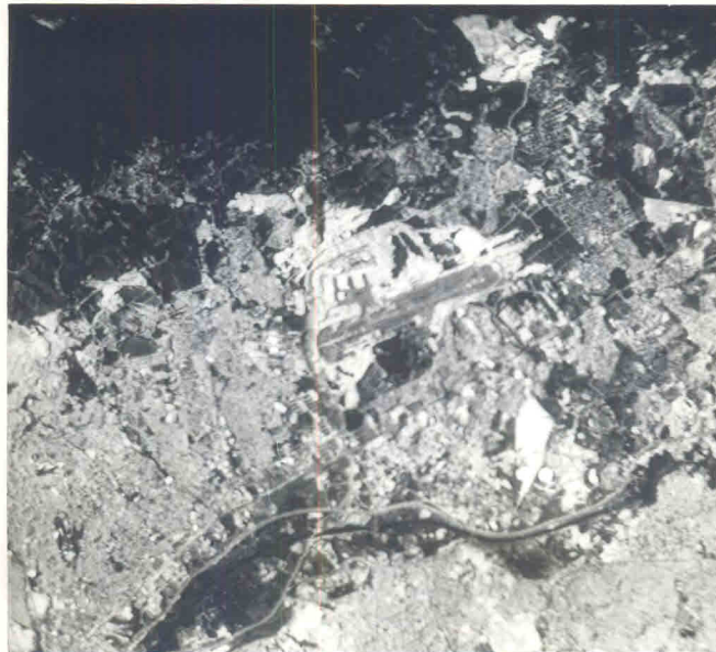
Fig.6-Imagem do TM original (512x512), banda 3, cobrindo o aeroporto de Cumbica, "pixel" = 30 m. -A região central de 256x256 "pixels" na imagem foi tomada para reamostragem.
