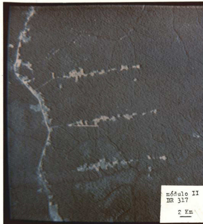
Fig. 5.2 - Resultado da filtragem isotrópica aplicada à banda 5 - m o du lo II BR 317.
