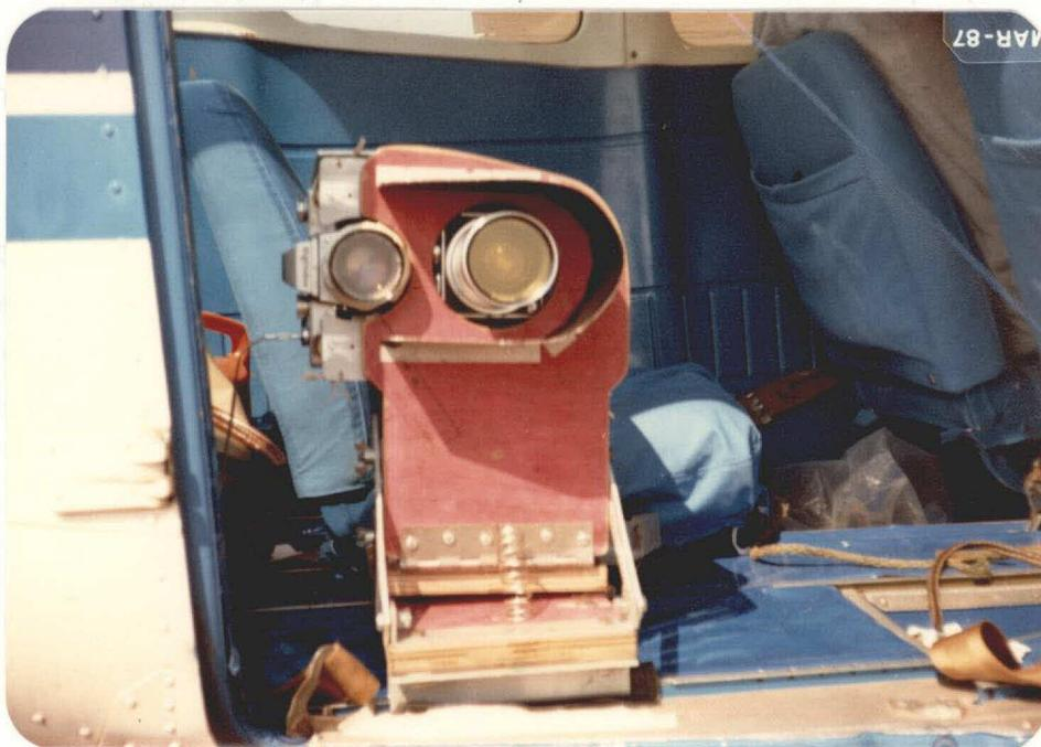
Fig. D.1 - Suporte equipado com duas câmaras fotográficas, uma de 35mm e outra de 70mm.
