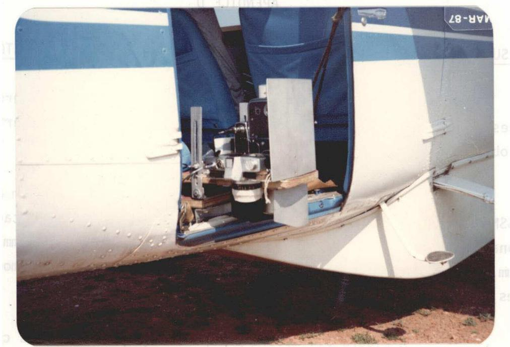
Fig. D.2 - Suporte instalado numa aeronave na posição de ser utilizado.
