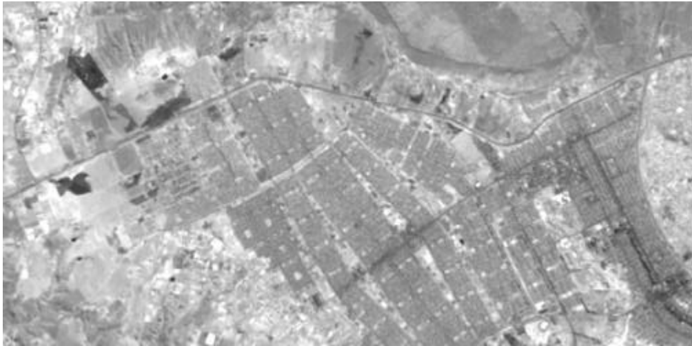
FIGURA 6.19 - Imagem interpolada por Convolução Cúbica, banda 4, pixel = 15 metros.
