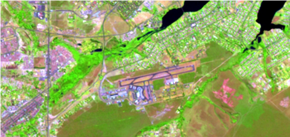
FIGURA 6.22 - Composição colorida com imagens interpoladas por convolução cúbica, (3B, 4G, 5R) com pixel = 15 m. Pista do Aeroporto.
