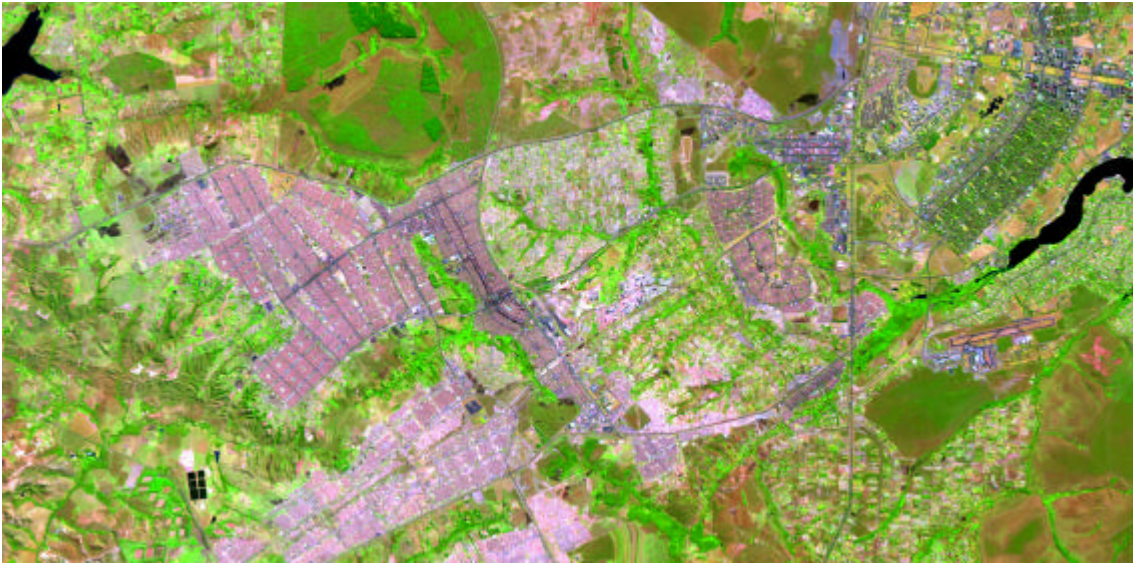
FIGURA 6.24 - Composição colorida com imagens originais, (3B, 4G, 5R) com pixel = 30 m.
