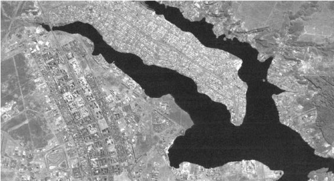
FIGURA 6.29 - Imagem restaurada, banda pancromática, pixel = 10 m.
