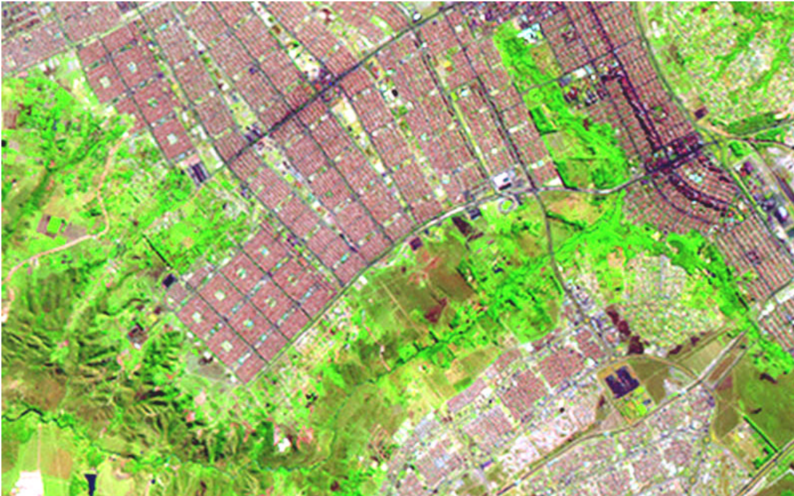
FIGURA 6.26 - Composição colorida com imagens restauradas, (3B, 4G, 5R) com pixel = 15 m.
