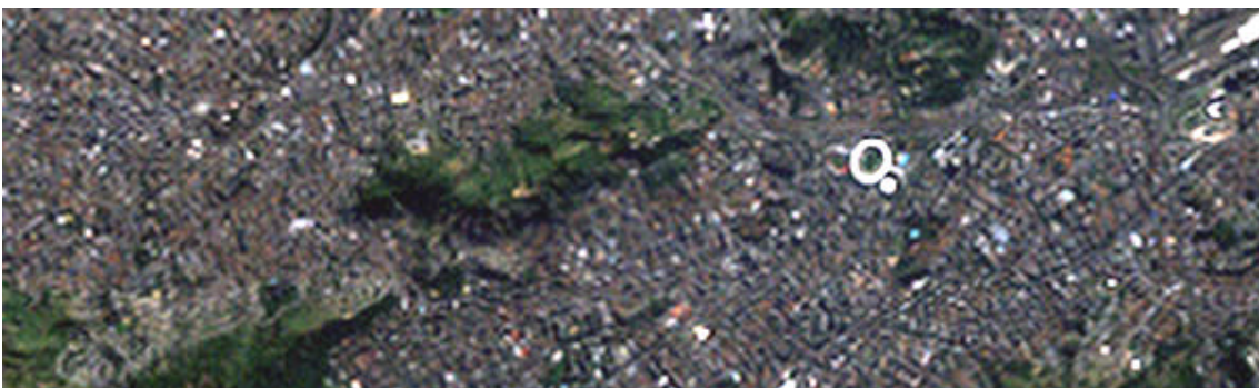
FIGURA 6.9 - Composição colorida com imagens interpoladas por ICC, (1B, 2G, 3R) com pixel = 15 metros. Estádio do Maracanã - RJ.
