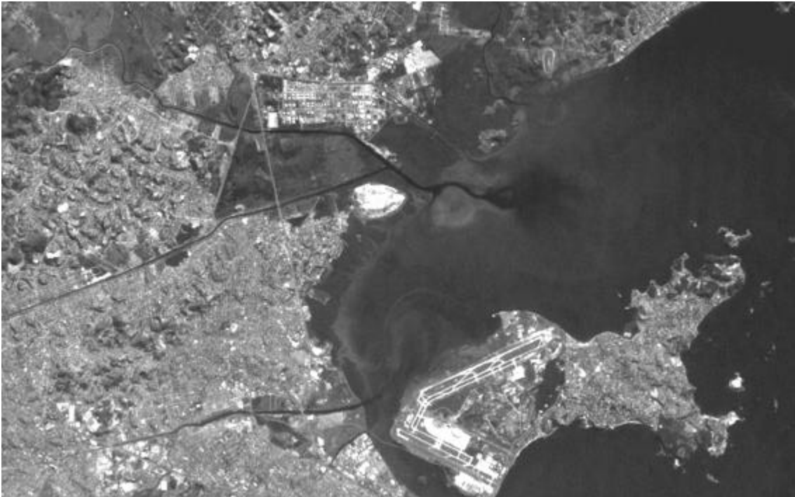
FIGURA 6.4 - Imagem interpolada por Convolução Cúbica, banda 2, pixel = 15 m.
