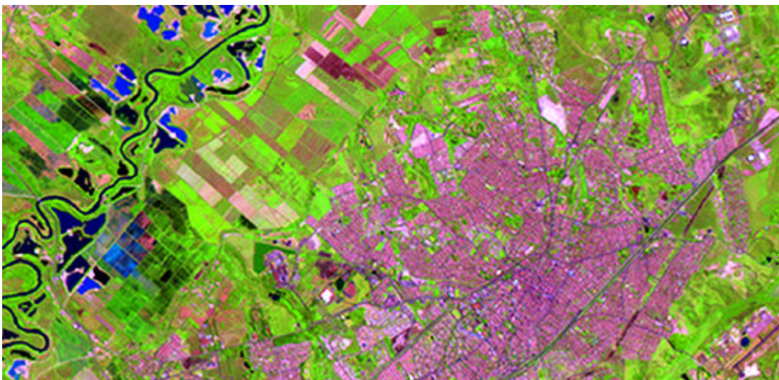
FIGURA 6.39 - Composição colorida com imagens restauradas, (3B, 4G, 5R) com pixel = 10 m.
