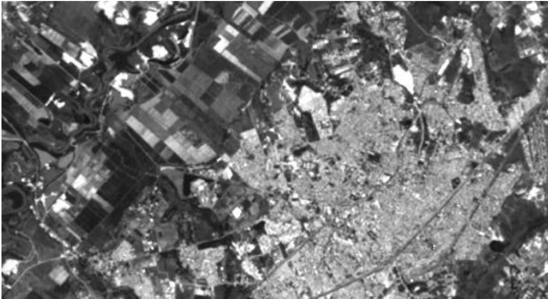
FIGURA 6.35 - Imagem interpolada por ICC, banda 3, pixel = 10 m.
