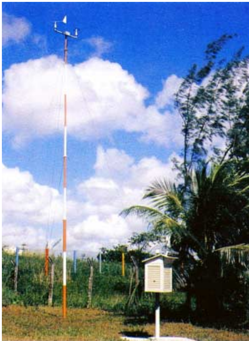
Figura 36 - PCD que estava instalada no INPE/NATAL, e servia para testar desenvolvimentos de partes operacionais do equipamento.
