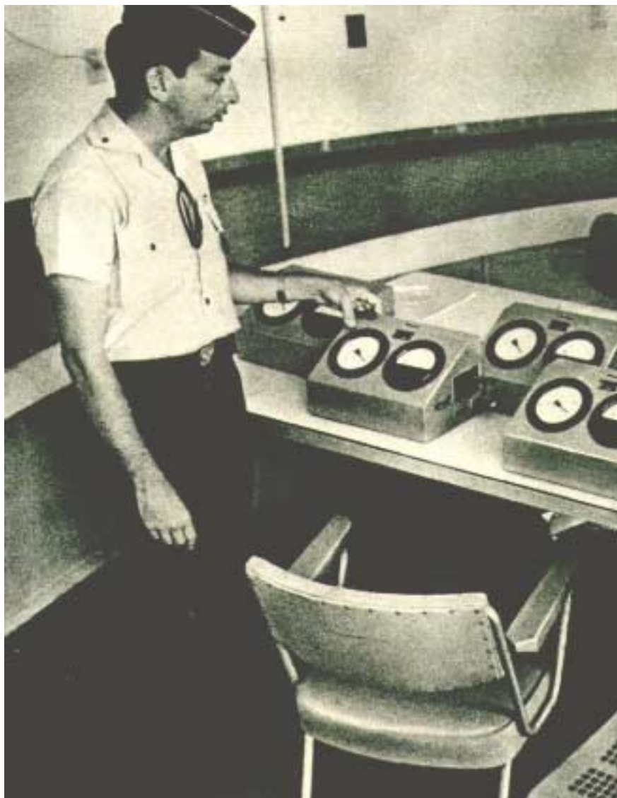
Figura 6 – O autor dentro da CASAMATA observando os indicadores de vento, para poder autorizar o lançamento. Foto de 1967.
