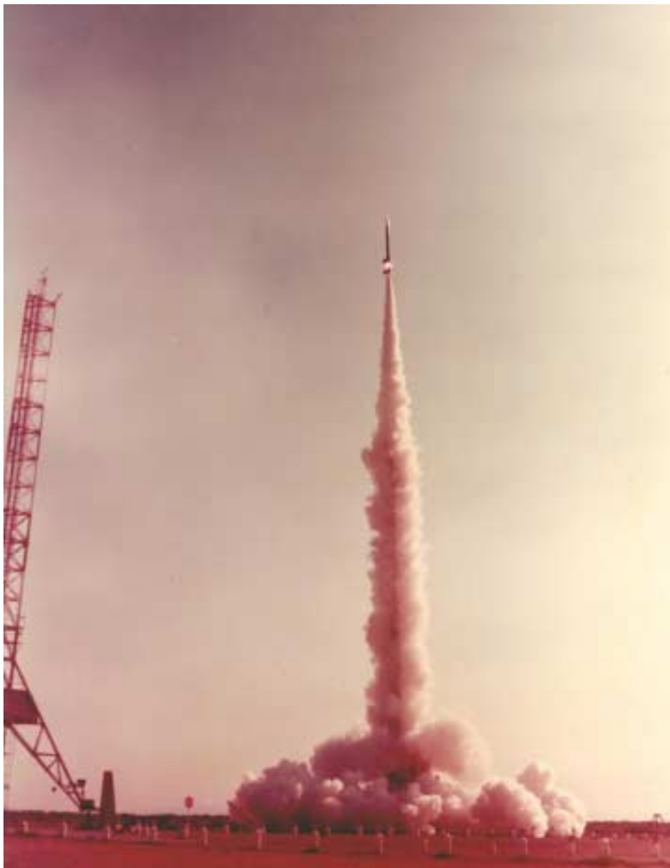
Figura 25 - Foguete AEROBEE após o disparo, onde nota-se a combustão simultânea do AEROBEE,(queimando os propelentes líquidos) e a queima do “booster”, com propelente sólido.
