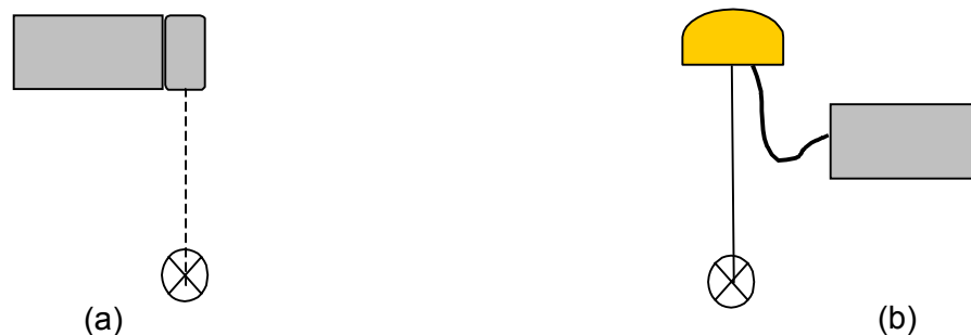
Figura 11: Ponto no terreno é materializado por meio da posição da antena do receptor do GPS a) Receptor com antena integrada e b) Receptor com antena externa.
