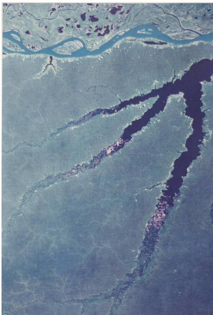
Fig. 4.7 - Imagem Landsat/TM, composição 3, 4, 5 (associada às cores azul, verde e vermelho respectivamente), mostrando a resposta espectral (cor magenta) característica de vegetação sem fisionomia florestal.
