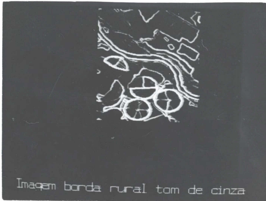
Fig. 6.31 - Borda morfológica em tom de cinza "operador de borramento e mínimo" real rural.
