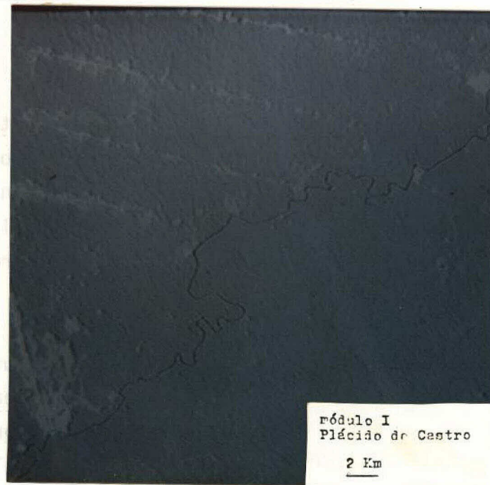
Fig. 5.1 - Resultado da filtragem isotrópica aplicada à banda 5 - m o d ulo I Plácido de Castro.
