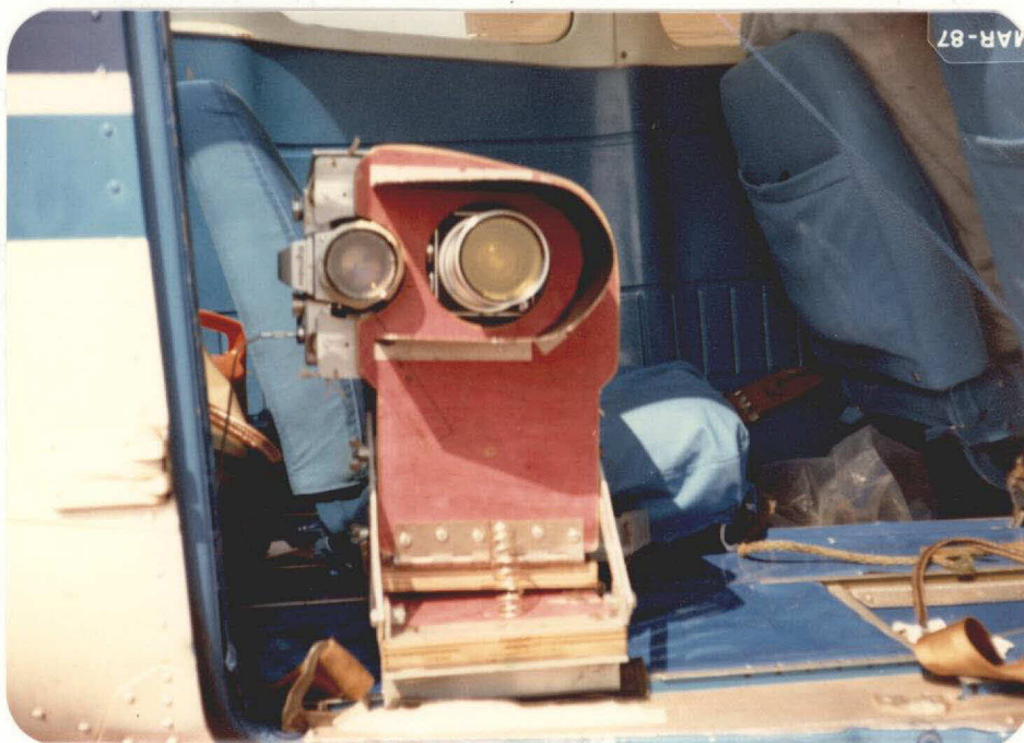
Fig. D.1 - Suporte equipado com duas câmaras fotográficas, uma de 35mm e outra de 70mm.
