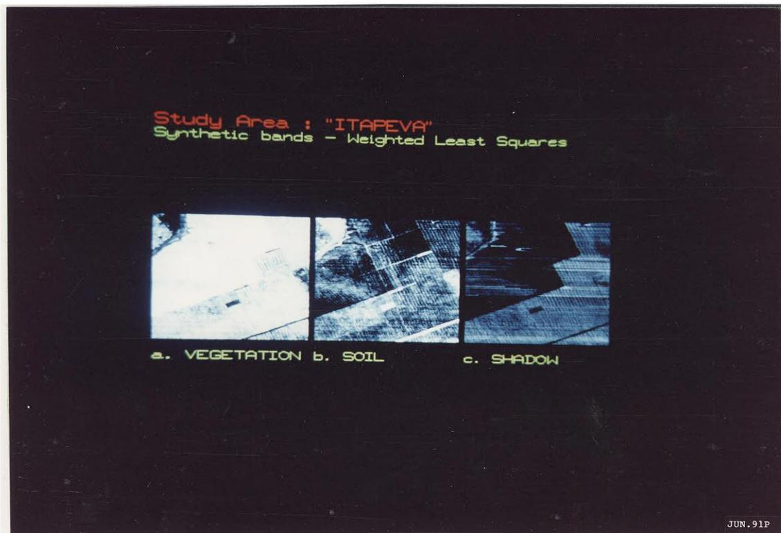
Fig. 5.5 - Bandas sintéticas geradas pelo MQP para o experimento "ITAPEVA": a) BANDA DE VEGETAÇÃO; b) BANDA DE SOLO; c) BANDA DE SOMBRA.
