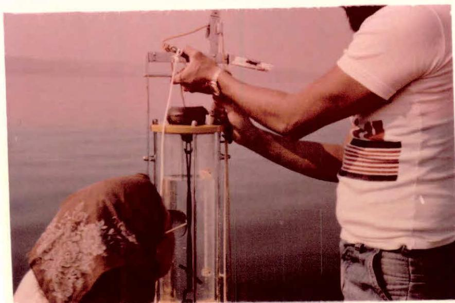
Fig. II.7 - Garrafa Hidrocean utilizada para coleta de amostras d'água a 5 e a 10 metros de pro fundidade.
