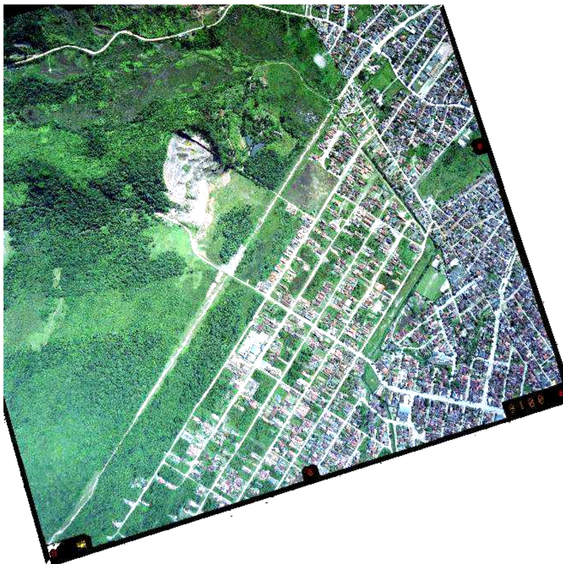
FIGURA 4.16 – Ortoimagem gerada. Foi obtida a partir de um MNE de espaçamento igual a 1 m e 2001 linhas por 2001 colunas.
