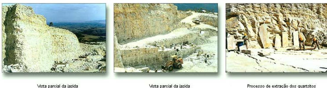
FIGURA 4.56 - Vistas parciais de uma jazida de quartzito. Notar na figura da direita a forma de extração em placas da rocha de quartzito.
