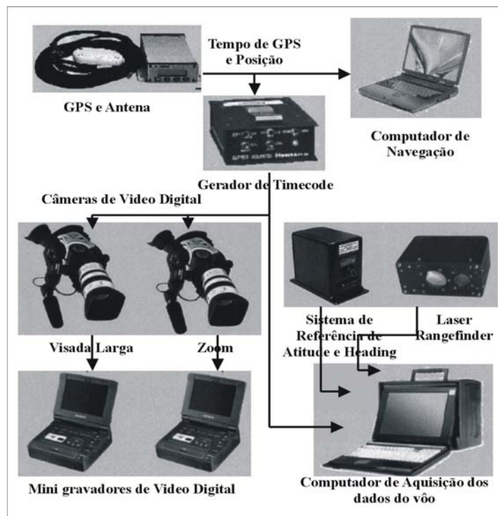
FIGURA 3.4: Sistema de aquisição da videografia digital utilizado no voo. O sinal do GPS diferencial OmniSTAR recebido pela antena de GPS Trimble 132 montada externamente foi convertido para o formato SMPTE pelo gerador de time-code Horita GPS3 e codificado no sinal de áudio das fitas de vídeo. O dado do GPS também foi usado na contínua atualização da rota de voo no computador de navegação. Duas câmeras digitais Canon XL-1 tanto no formato de visada larga quanto no zoom foram utilizadas simultaneamente e os filmes foram gravados em fitas DAT. Os dados do Sistema de Referência de Atitude (SRA-Watson Industries BA303 AHRS- attitude and heading reference system), do Laser Atlanta (laser rangefinder) e do GPS foram gravados pelo computador de aquisição dos dados do voo para pós-processamento. FONTE: Adaptada de Hess et al, 2002, p. 1534).
