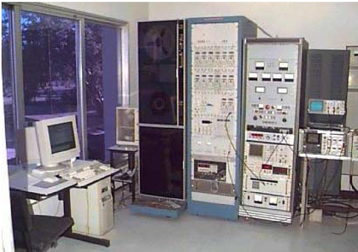
Figura 46 - Equipamentos que compõem a Estação rastreadora MARK III.
