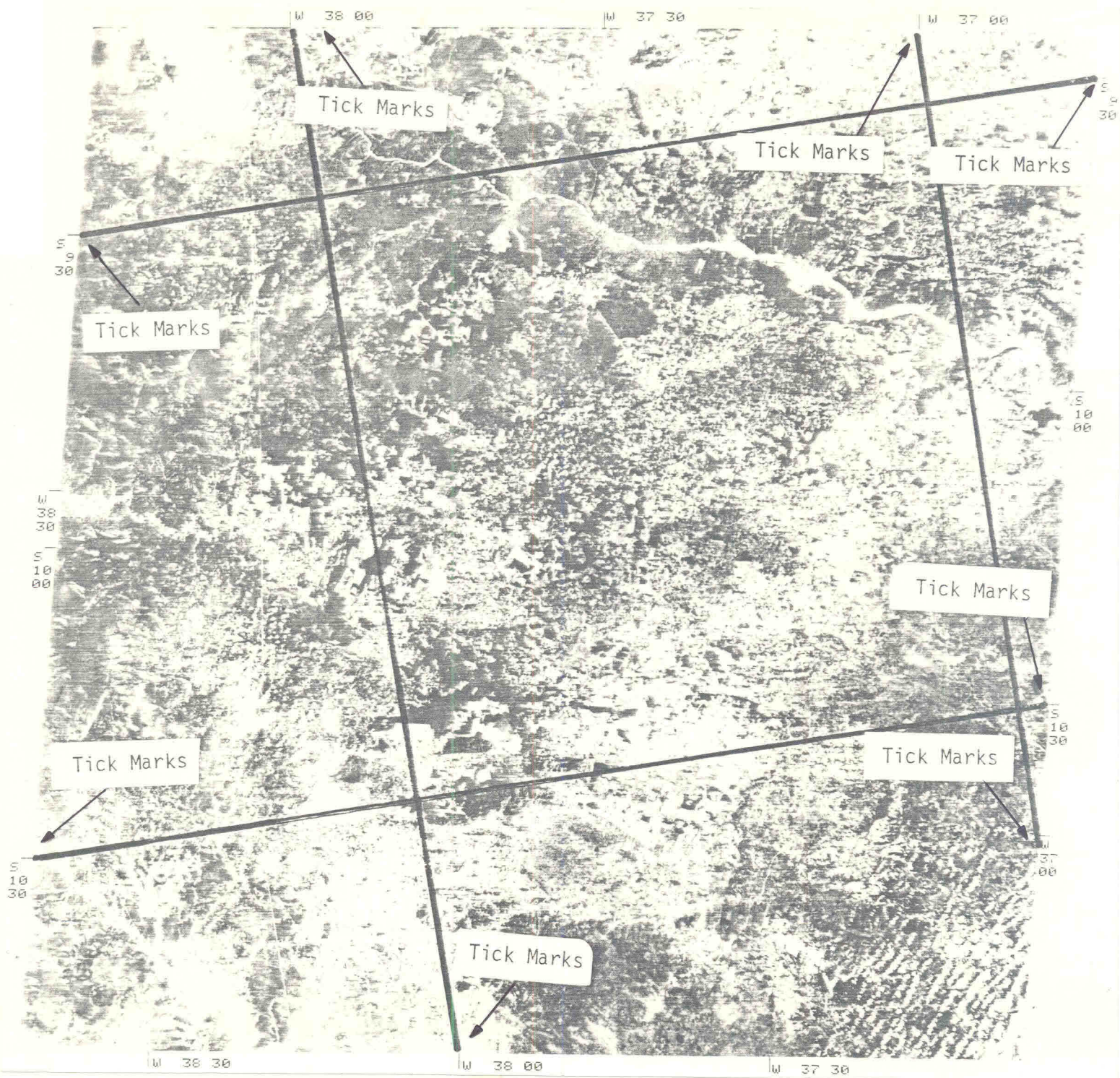
Fig. 3.4 - Imagem definindo quadrículas de 1^0 através dos "Tick Marks".
