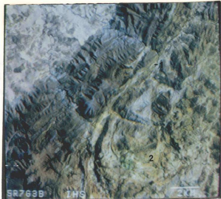
Fig. 5.18 - Composição 5R7G3B, com pré-equalização das médias e ampliação linear nos componente I e S.
