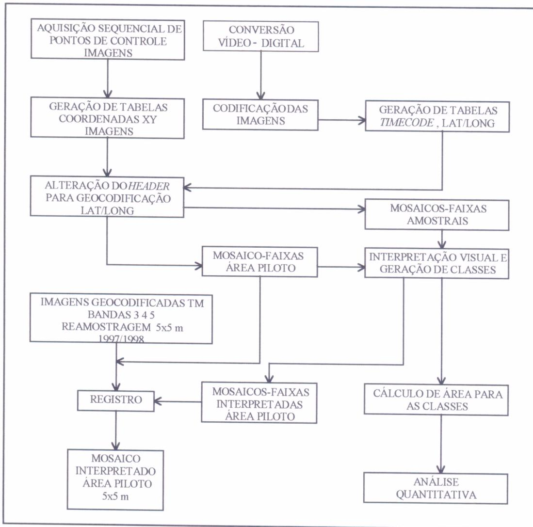
Fig. 6 – Fluxograma da fase de processamento das imagens videográficas.
