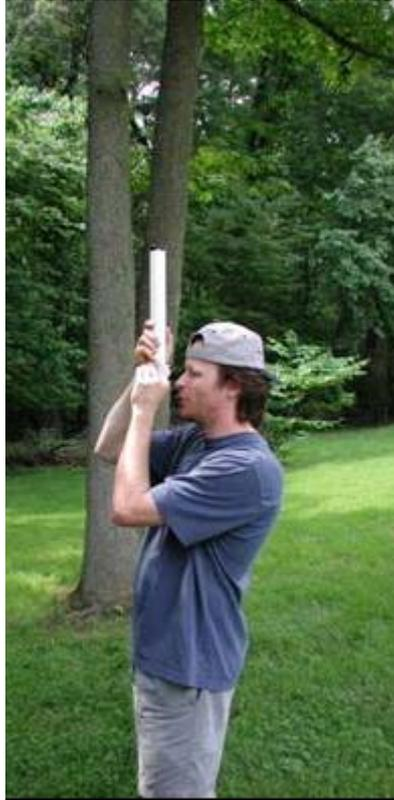
FIGURA 3.4 – Densidômetro utilizado para a coleta de informação de porcentagem de cobertura arbórea no trabalho de campo. Este equipamento coleta apenas uma medida pontual.
