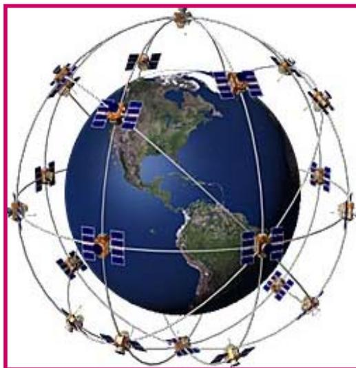
Figura 1: Constelação dos satélites do sistema GPS.
